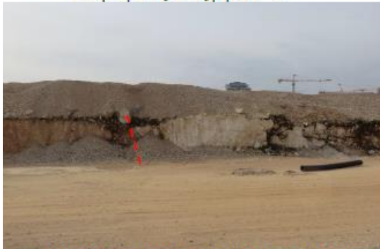
4. מעבר בין סלע חלש קרסוני לחזק גירי (יתכן חצר משמאל או סדק עם תנועה אנכית עליו) אזור בלוי עם חדירות חרסית מימין
